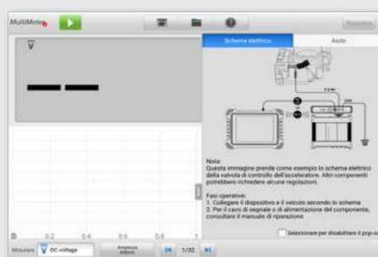
La funzione multimetro prevede tutte le funzioni di lettura: tensione, amperaggio, resistenza, prova diodi, continuità, verifica di frequenza con visualizzazione grafica e supporta pinze amperometriche.
