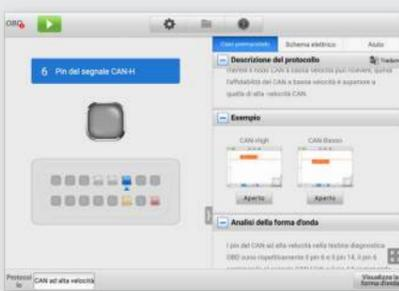
È possibile verificare lo stato della linea CAN direttamente dalla presa EOBD.
