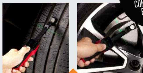
**Analisi precisa (0,1 mm) e completa della profondità del battistrada e controllo rapido del disco del freno**
