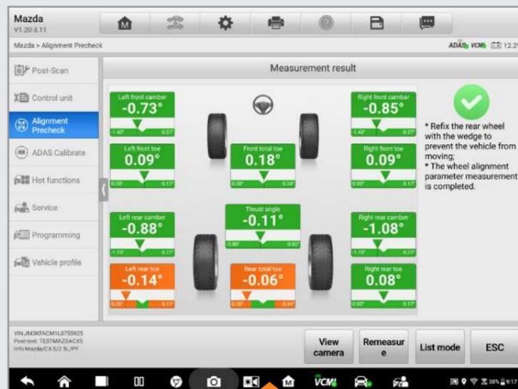
Grazie ad IA800 è possibile individuare rapidamente il disallineamento delle ruote che può compromettere la corretta calibrazione dei sistemi ADAS.
