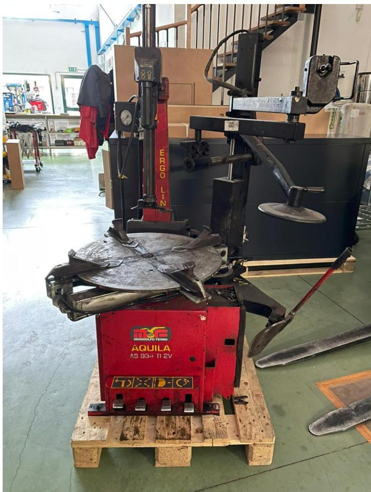
AS 934 è uno smontagomme superautomatico con piantone a ribaltamento pneumatico, per ruote vettura e trasporto leggero da 10" a 23" e larghezza fino a 12".
